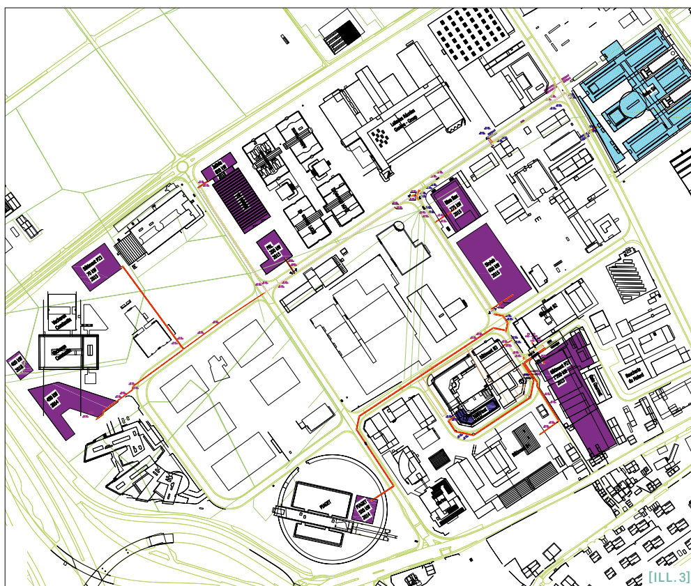
[ILL. 3] Grâce à la mutualisation, 75% des besoins en chaleur de la zone industrielle de Plan-les-Ouates sont assurés par la récupération des rejets thermiques. En bleu les bâtiment produisant un surplus de chaleur, en violet les bâtiments recevant la chaleur. (Source: FTI)
